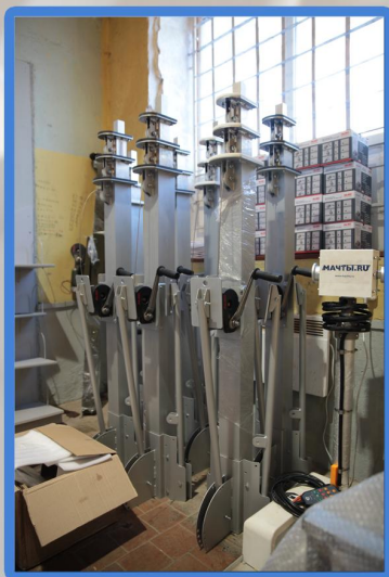
Мачта ММО-5,5 (высота 5,5 м) с триподом, в сложенном виде
